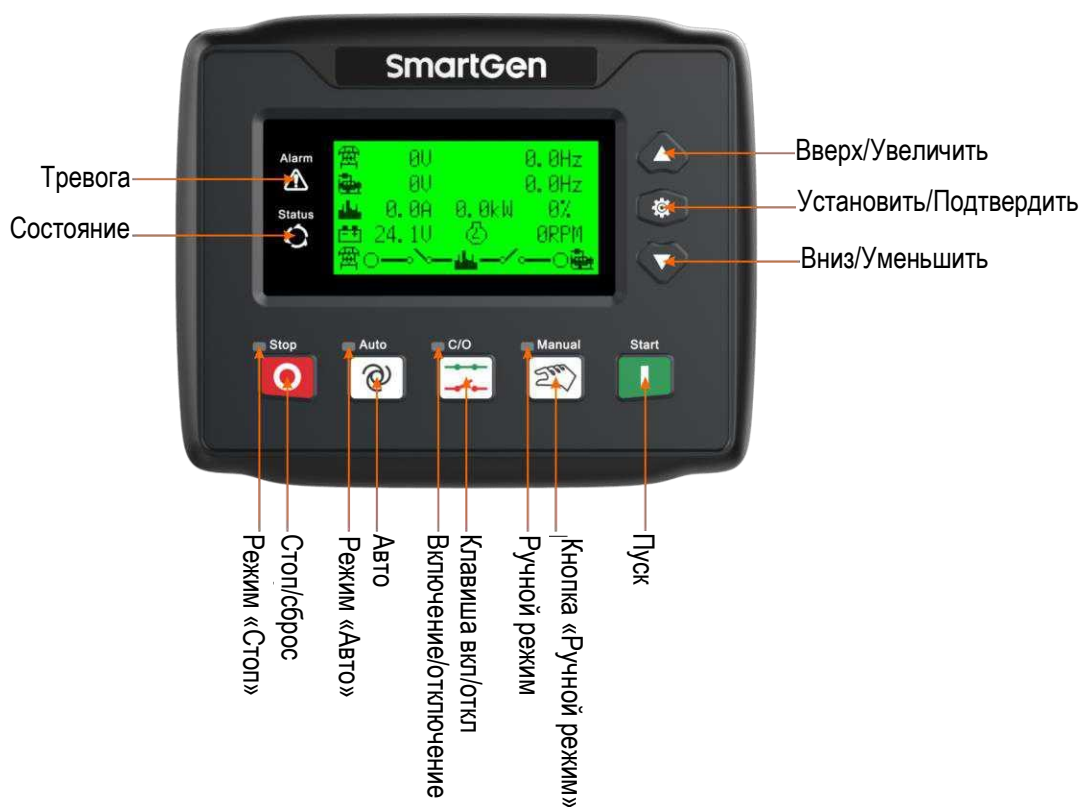
HGM4020NC Индикация на передней панели
